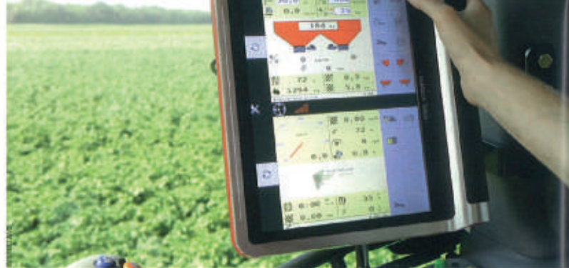
L'objectif de l'Isobus est que tous les équipements électroniques parlent le même langage. L'offre d'équipement « réellement » Isobus se développe bien depuis quelques mois.
