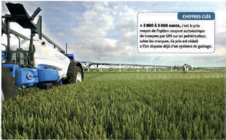
La largeur croissante des rampes de pulvérisateur favorise le recours aux automatismes GPS.
