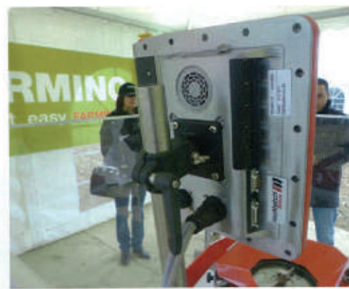
Le boîtier isomatch Tellus est riche en connexions USB, RS 232, Ethernet RJ45, ECU Iso 11789 ou Isobus 11783 pour échanger ses données avec l'outil, le tracteur, Internet, une antenne GPS ou un ordinateur.
