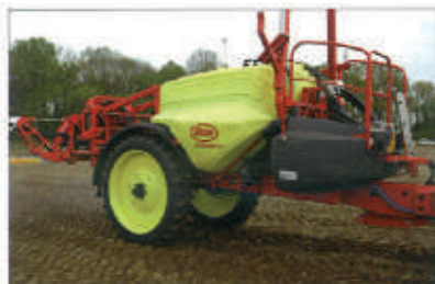
L'IX Track C-40 de Vicon (4 000 l de capacité de cuve) est équipé de série d'une suspension hydraulique qui assure une suspension douce tout en limitant l'amplitude des débattements. Cela favorise le suivi de la rampe et une hauteur constante des buses.
