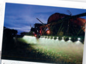
La pulvérisation de nuit s'éclairage beaucoup plus soigneusement, avec la coupure automatique des tronçons.
