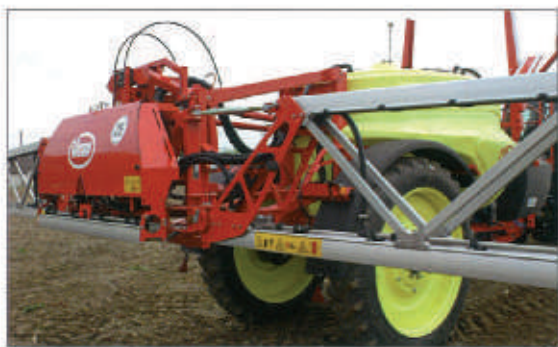
Pulvérisateur traîné IX Track C-40, de Vicon. Le parallélogramme comporte deux vérins hydrauliques équipés de boîtes d'azote pour la suspension. Un verrouillage mécanique est actionné automatiquement lors du repliage en position transport (2,55 m de largeur). Quand la rampe est dépliée, les lignes des vérins sont rentrées.
