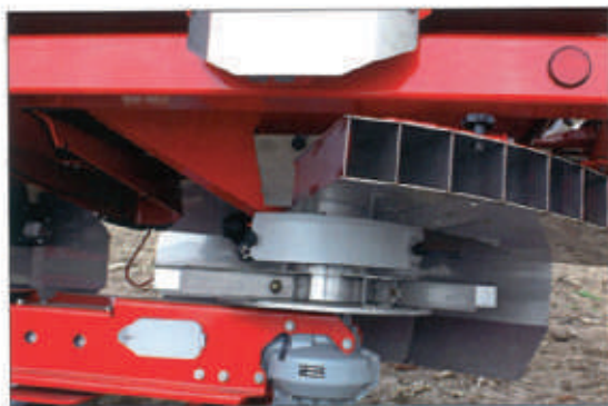
Distributeur d'engrais Exacta TL-A Geo Spread, de Kverneland. Avec la distribution Centre Flow, il n'y a pas de choc, ni bruyage, ni poussière. Le point de chute de l'engrais est central, l'accélération progressive. La force centrifuge donne de la vitesse à l'engrais avant qu'il ne soit pris en charge par les pales (six à huit par disque).
