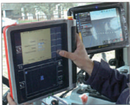
Terminal Isomatch Tellus, de Kverneland. L'application Geo Control donne accès aux modules de l'agriculture de précision : guidage, fonctions d'arpentage, « Stop and go », coupures de sections pour les recouvrements et le travail dans les pointes, modulation de dose, contrôle et documentation des tâches, etc.
