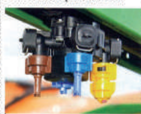
La commande électrique des porte-buses permet la coupe et la sélection individuelle de chaque buse.
